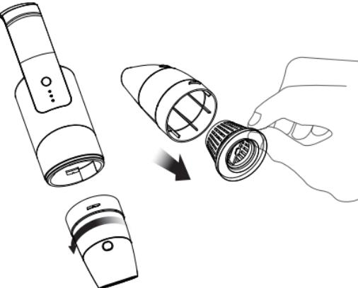
外したフィルター金具の手前を右にまわして外します。
